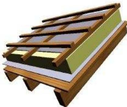
con l'aggiunta di 10 cm di coibentazione (su richiesta) il tetto raggiunge un isolamento di U=0,14 W/m<sup>2</sup>K
